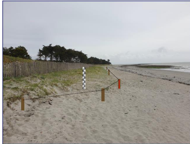
Mesure au niveau de la bande rouge et/ou de la perche (exemple en cas d'installation de mono-fil)
